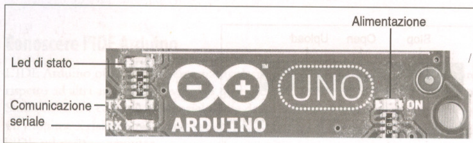
Figura 1.8 La scheda Arduino presenta una serie di led.
